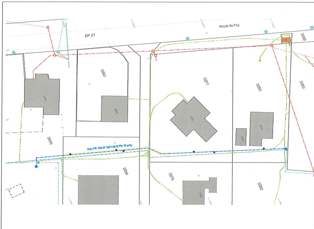
Après les travaux de fouille, les chaussées traversées seront réfectionnées sur l'emprise de la fouille. Pour ceci, le projet prévoit de refaire l'encaissement avec 50 cm de grave surmontés d'une couche de 10 cm d'enrobé ACT 22N et d'un tapis de 4 cm d'AC 11N. Les autres aménagements seront remis en état à l'existant.
